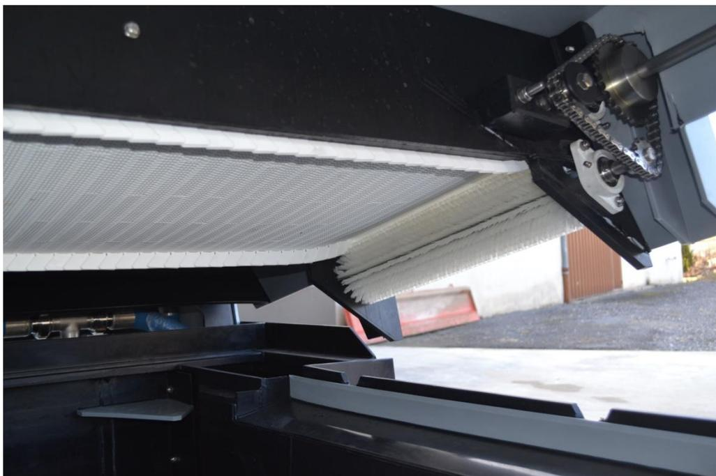
➔ EFFICACITE DE LAVAGE OPTIMISE PAR UNE BROSSSE MECANISEE EN PLAFOND DE TUNNEL
